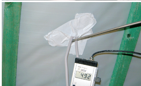
Контроль воздухопроницаемости зондом
