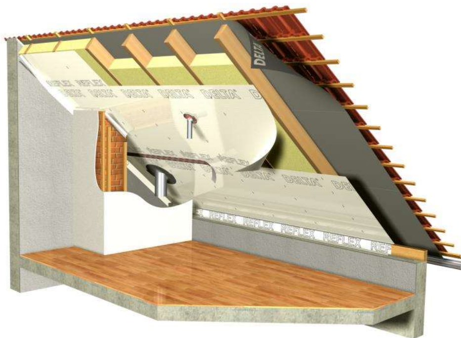
Рис. 1 Система изоляции мансарды.
